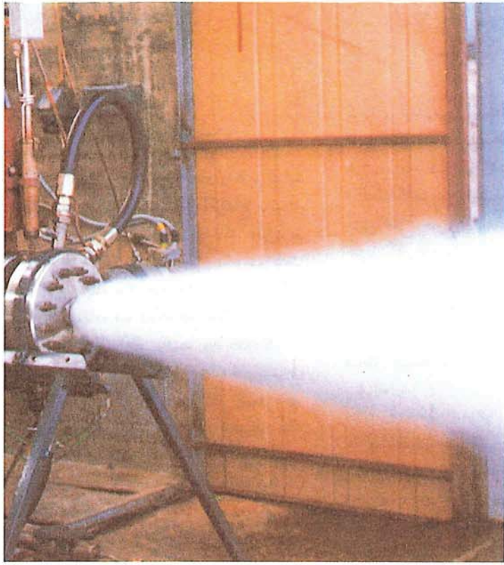
توربين تجارب يعمل بغاز الهيدروجين الممزوج بالاكسجين
